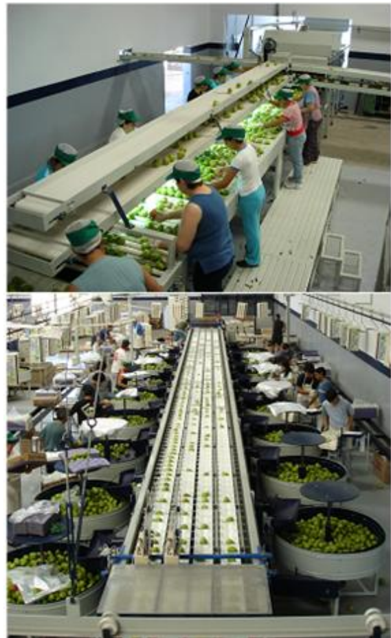
Fig. 1: (Arriba) El proceso manual de clasificación de color y defectos. (Abajo) La línea de transporte con 4 líneas. Pueden verse los depósitos circulares a ambos costados.
