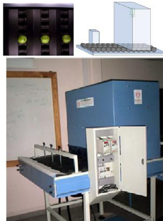
Fig.3: (Izq.) Captura desde adentro de la caja de ambiente controlado mostrando tres líneas. (Der.) Esquema del prototipo montado. (Abajo) Prototipo implementado de pruebas
